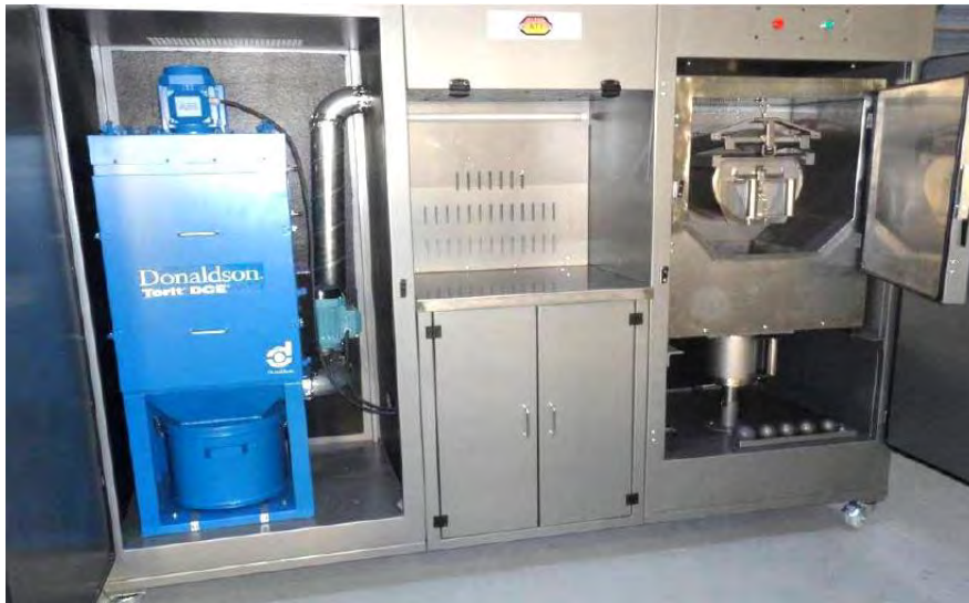
Figure 10 : Pulvérisateur de calcius et cabinet de transfert
